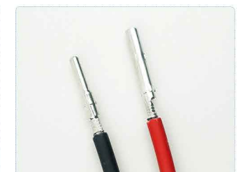
使用压线钳，将铜件插针正负极固定在已剥的光伏电缆上，备用。固定后耐20kg以上拉力。
